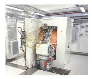
Figure 5: The PETtrace p/d cyclotron.
